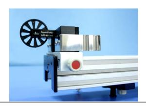
當台車需要拉力,藉由砝碼的拉力經過滑輪時, 請將項目 10.插削定滑輪安裝在項目 7. 台車停止 裝置的後方即可。如圖
