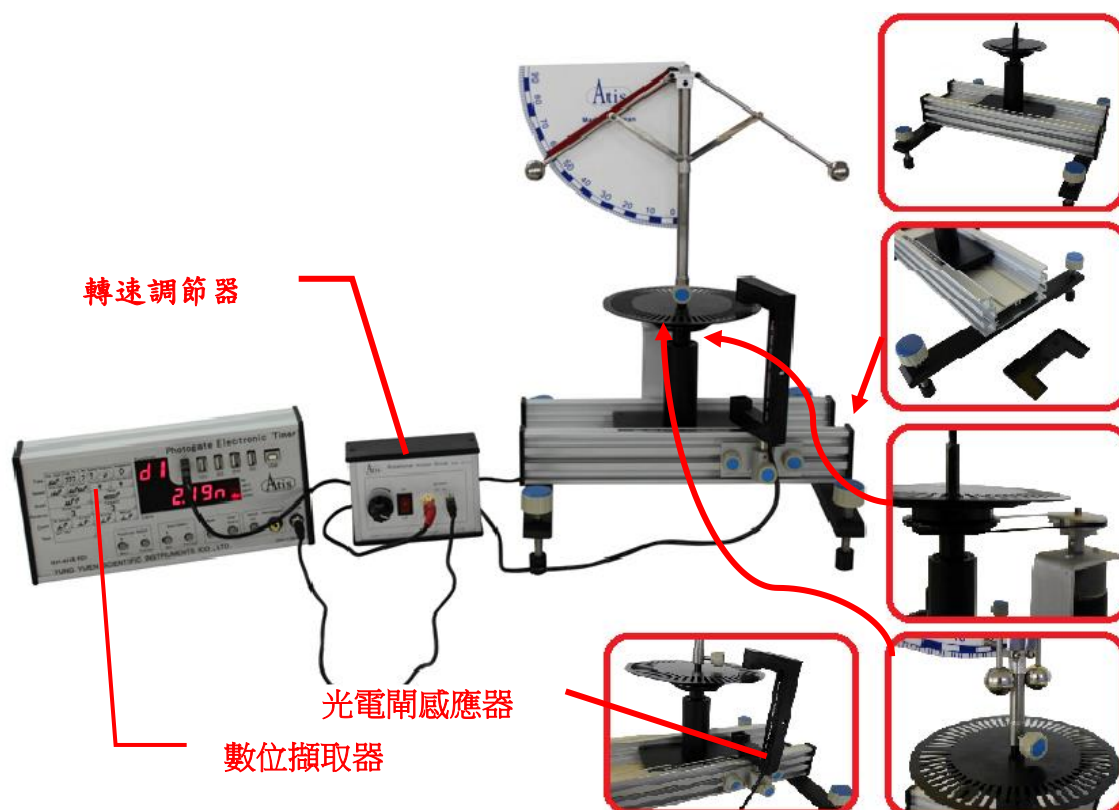
圖(1-2) 重球式離心力實驗組裝圖
