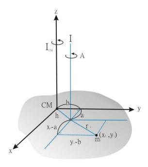
如圖設轉軸方向為 z 軸方向,且以質心為座標圓點 $(x_{CM} = y_{CM} = 0)$ ,故質點  $m_i$  對 A 軸之轉動慣量為:
