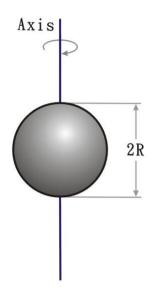
首先,先帶入球座標 $(r,\theta,\phi)$ 的觀念,如上圖 ,可知:  $dv=r^2\sin\theta dr d\theta d\phi$  假設體密度為  $\rho=\frac{M}{V}=\frac{\int dm}{\int dv}=\frac{M}{\frac{4}{3}\pi R^3}$  ,又 dm 與 z 軸的距離為  $r\sin\theta$  ,所以:
