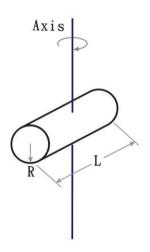
我們將圓柱切成一片片極小的圓盤,且每片圓盤質量為dm,我們以繞著圓盤的直徑為轉軸時, 其轉動慣量在上面已算過,為 $I=\frac{1}{4}MR^2$ ,再由平行軸定理可知:
