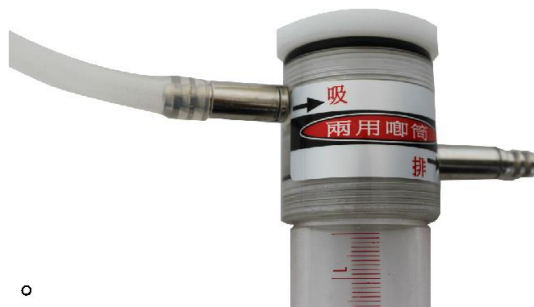
圖 3-3 抽壓兩用唧筒吸氣孔端裝置示意圖
