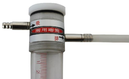
圖 3-2 抽壓兩用唧筒排氣孔端裝置示意圖
