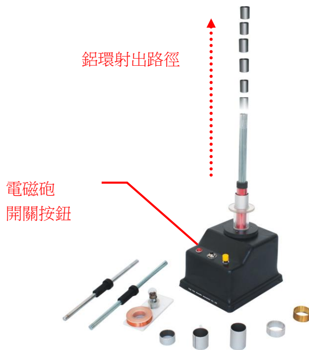
圖(1) 電磁砲實驗圖
