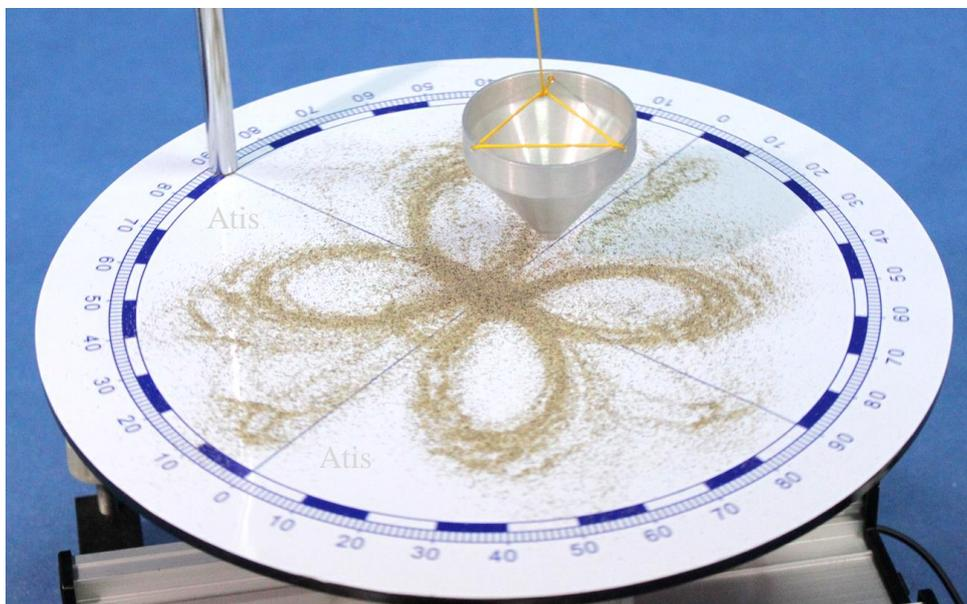
圖 4-4 利用細沙在轉盤上繪出傅柯擺的運行軌跡。
