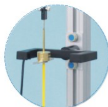
光電閘方便固定
