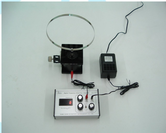
圖(4-1) 封閉金屬圓環駐波實驗裝置圖
